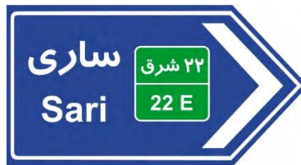
شکل ۱۲: نمونه ای از تابلوی راهنمای مسیر خروجی که در آزادراه نصب می شود
