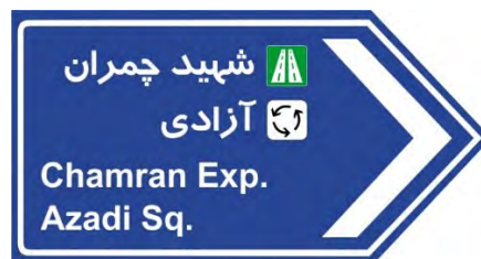
شکل ۱۱: نمونه ای از تابلوی راهنمای مسیر خروجی که در آزادراه نصب می‌شود ۹
